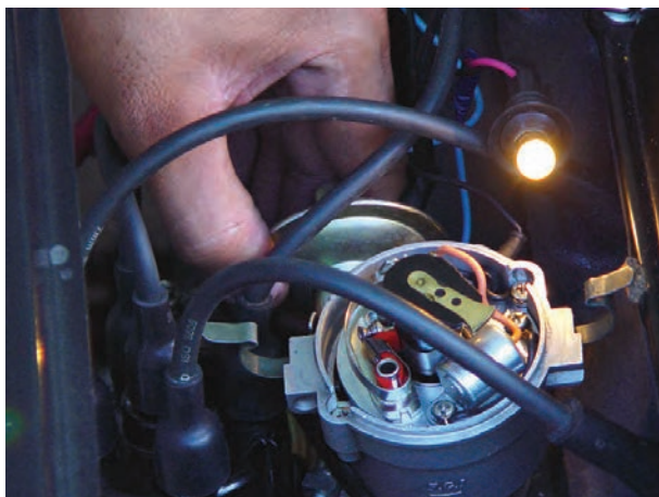
شکل ۶۰-۱۰ - لحظه‌ی باز شدن دهانه پلاتین و روشن شدن لامپ
