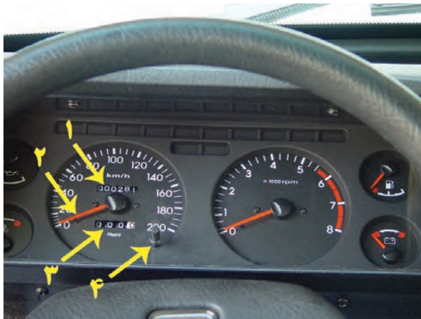
۱- کیلومتر شمار اصلی ۲- سرعت سنج ۳- مسافت سنج ۴- صفر کن مسافت سنج شکل ۴-۱۲- سرعت سنج و کیلومتر شمار
