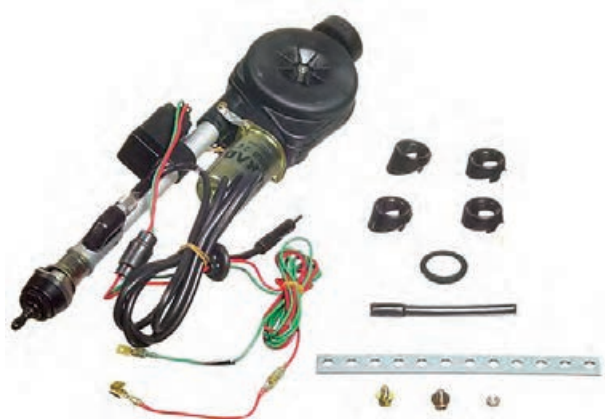
شکل ۹-۵ آنتن الکتریکی قابل نصب در گل‌گیر خودرو و متعلقات آن
