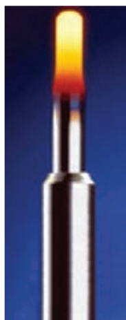
شکل ۳-۱۳ - شمع گرم کن در حالت گداخته بودن
