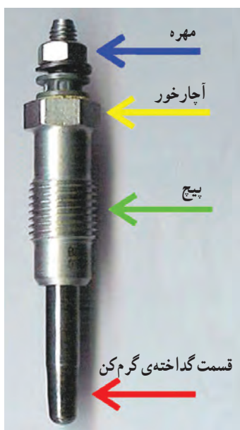
شکل ۲-۱۳ - شمع گرم کن موتور دیزل
