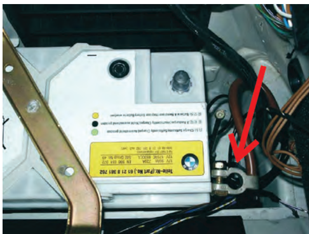
شکل ۹-۱۱- باز کردن کابل اتصال بدنه ی باتری
